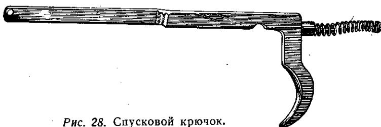
Рис. 28. Спусковой крючок.
