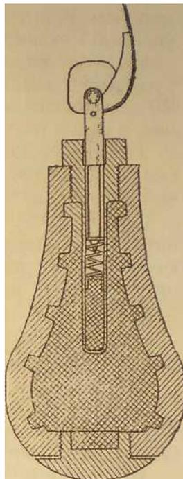
церином Корпус прикреплялся к рукоятке, в которой размещался ударный механизм. В служебном обращении на корпус гранаты напевался предохранительный чехол, состоящий из двух стальных полушарий. Предполагалось, что при ударе о преграду заряд жидкого ВВ растекается по броне, обеспечивая максимальное соприкосновение, а взрыватель ударного действия обеспечит его подрыв.
