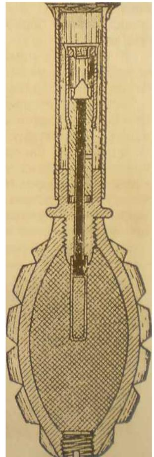
фиксирувался при помощи эксцентрика-предохранителя. В служебном обращении рычаг эксцентрика привязывался к корпусу при помощи шнура. К рычагу привязывалась лента-стабилизатор. Перед броском шнурок снимался и граната металась в цель.
