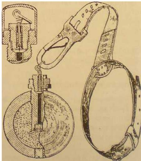
релы. В конце 19 века после Франко-Прусской войны деревянная трубка была заменена на латунную. Граната с подобным запалом состояла на вооружении русской армии. К кольцу терочного устройства, при помощи карабина присоединялся специальный кожаный браслет, надеваемый на руку перед броском. Вес гранаты составлял 1,23 кг. Снаряжалась она черным порохом.
