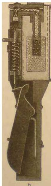
Она имела прямоугольный в плане корпус, изготовленный из цинка. Корпус крепился к деревянной рукоятке.
