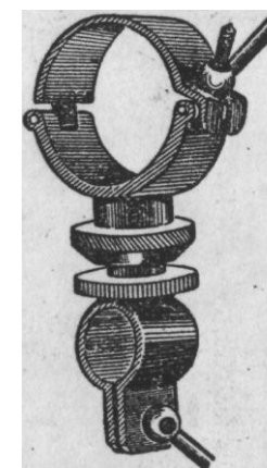
Рис. 12. Детали установочного приспособления для прикрепления ' малокалиберного пулемет» к пулемету ДП или к его деревянному макету
